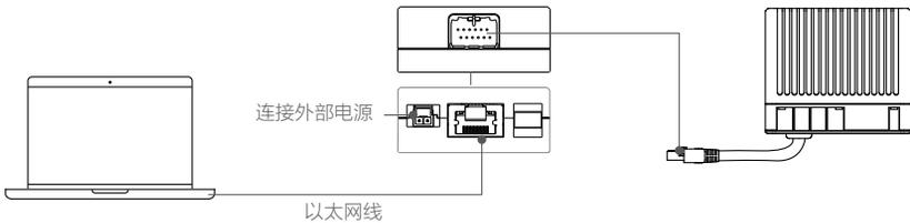
图 4.2.2 静态 IP 模式的连接方式
