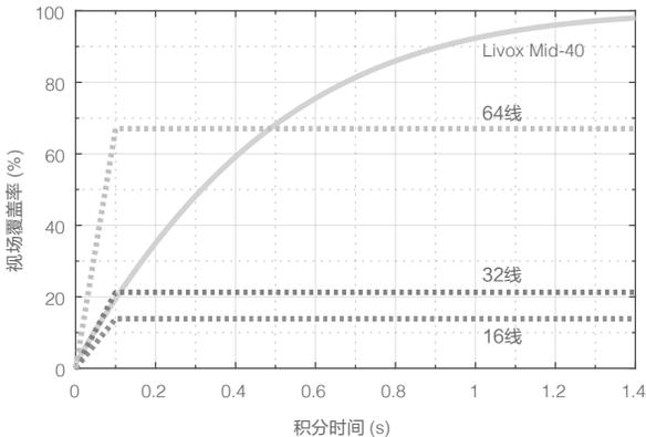
图 1.2.3 Livox Mid-40 以及当前市场上常见的几种多线机械旋转式激光探测测距仪不同积分时间下的视场覆盖率。其中，64 线 /32 线 /16 线产品的竖直 FOV 分别是  $30^\circ$  /  $41^\circ$  /  $27^\circ$ 。
