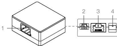
1. 激光探测测距仪连接头接口
