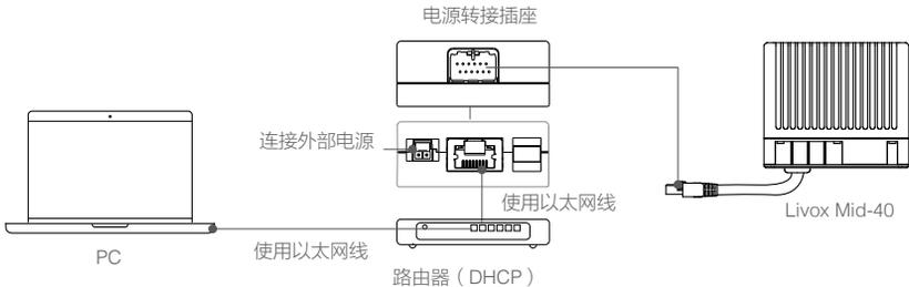
图 4.2.1 动态 IP 模式的连接方式
