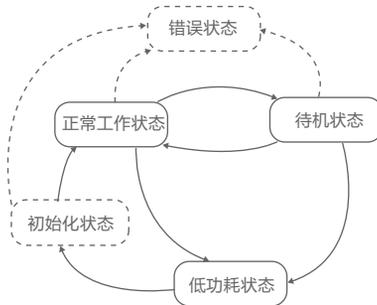
图 5.2.1 不同工作状态的关系示意
