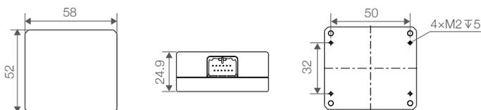
图 3.2.4 电源转接插座尺寸结构（大图请查看附录 4）
