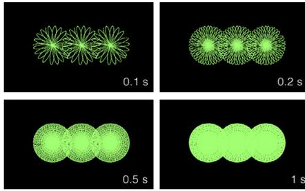
图 1.2.2 Livox Mid-100 不同积分时间内点云效果图
