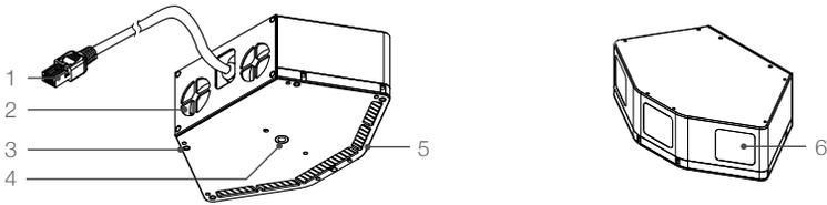
1. 激光探测测距仪连接头
